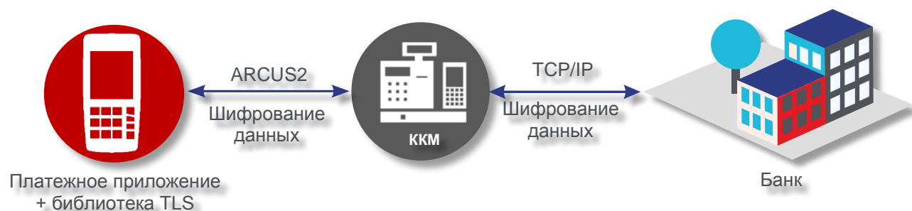
Рис. 2. TLS шифрование в режиме IP через кассу
