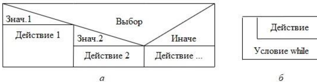
Рис. 1.17. Нотация Насси–Шнейдермана, дополнительные структуры: а – switch; б – цикл с постусловием (do-while)
