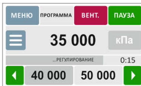
3. ОКНО «ПРОГРАММА» В СОСТОЯНИИ «ПЕРЕЗАПОЛНЕНИЕ»
