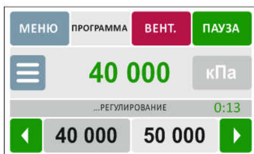
2-2. ОКНО «ПРОГРАММА» В СОСТОЯНИИ «РЕГУЛИРОВАНИЕ» ПРИ ВЫХОДЕ НА ДАВЛЕНИЕ УСТАВКИ
