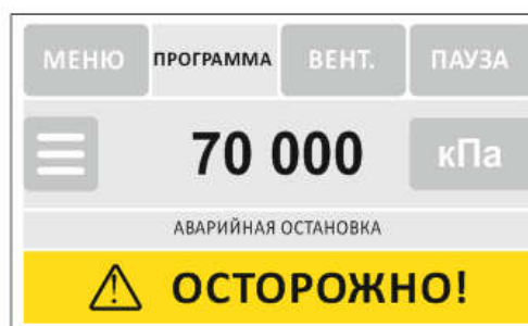
7. ОКНО «ПРОГРАММА» В СОСТОЯНИИ «АВАРИЙНАЯ ОСТАНОВКА»
