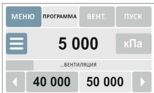
4. ОКНО «ПРОГРАММА» В СОСТОЯНИИ «ВЕНТИЛЯЦИЯ» (СБРОС ДАВЛЕНИЯ В НОЛЬ ПО ОКОНЧАНИЮ ПОВЕРКИ)
