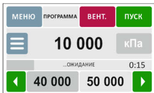
2-2. ОКНО «ПРОГРАММА» В СОСТОЯНИИ «РЕГУЛИРОВАНИЕ» ПРИ ВЫХОДЕ НА ДАВЛЕНИЕ УСТАВКИ
