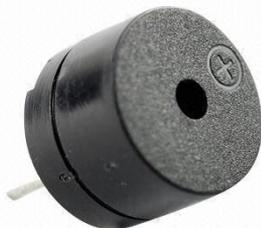
Часто, для звуковой индикации используется специальный прибор, называемый зуммером. В отличие от динамика, в зуммере есть небольшой встроенный генератор звуковой волны определенной частоты, поэтому он может выдать только одну ноту. Это значительно упрощает работу с ним. Нам достаточно просто подать на него питание, и зуммер запищит.
