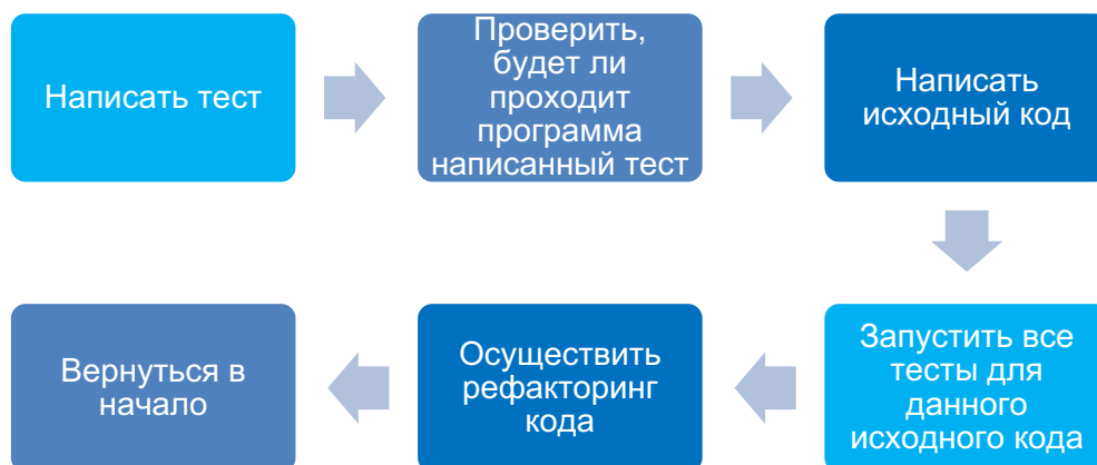
Рисунок 38. Цикл разработки в случае применения модульных тестов
