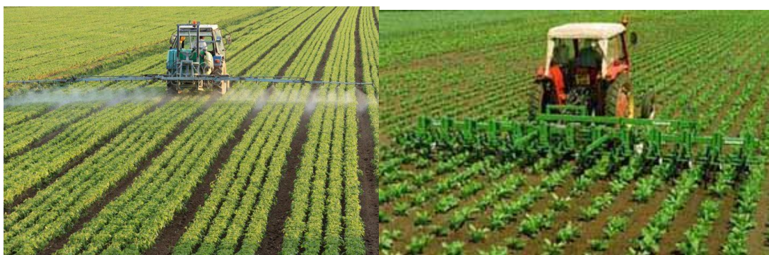
Рис. 1.1 Слева трактор, опрыскивающий поле, использующий отдельную управляемую секцию штанги, чтобы опрыскивать ряд с сорняками, справа - трактор с рыхлительным оборудованием, которое может подниматься или опускаться системой управления. Система обнаружения сорняков может запрограммировать его автоматически опускаться только при наличии сорняков.
